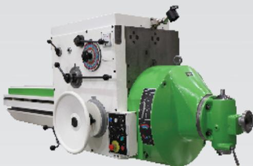
Der Fräskopf FP40-100 ermöglicht ein Fräsen in den parallel zur Arbeitsspindelachse verlaufenden geneigten sowie Grundebenen oder ein Bohren in den rechtwinklig zur Arbeitsspindelachse verlaufenden Grundebenen.
