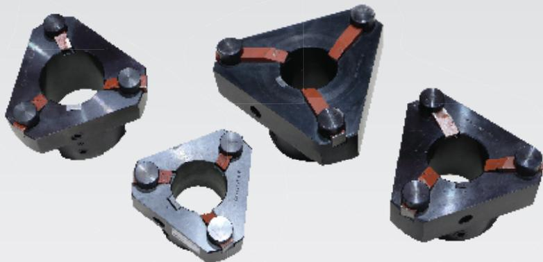
Die Dreiflügel-Bohrmei- ßel werden zusammen mit den Bohrstan- gen VT80, VT100 zum Bohren komplizierter und tiefer durchgehender Öffnungen mit hohem Anspruch an Genauigkeit und Gleichachsigkeit verwendet.
