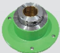
Die Spindelklemmstütze SP100/800 erhöht die Steifigkeit des Arbeitsspindellagers und ermöglicht damit eine Erhöhung der Zerspanungsparameter bei einer über 200 mm ausgefahrenen Spindel und bei einer leichten Reduzierung des Drehzahlbereichs der Spindel ohne die Möglichkeit, diese in der Achse W zu verstellen.
