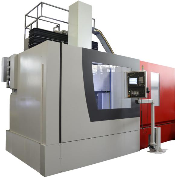
**BASICTURN 1250 C2      06/2020****Siemens Sinumerik 840D SL****X, Z, C****Manuelle Planscheibe mit 4 Backen****Schieber 200 x 240 mm****Max. Werkstückhöhe: 1 400 mm****Max. Werkstückdurchmesser: 1 400 mm****Scheiben-Werkzeugmagazin für 12
